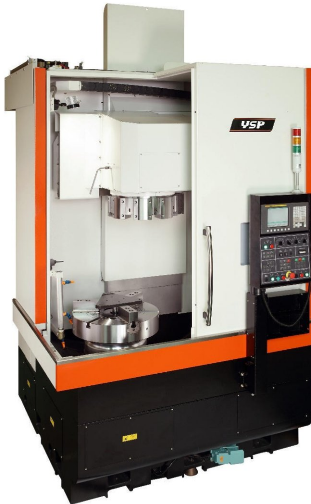
Рисунок 2.3 – Токарно-карусельний верстат з ЧПК YSP VL-850R
